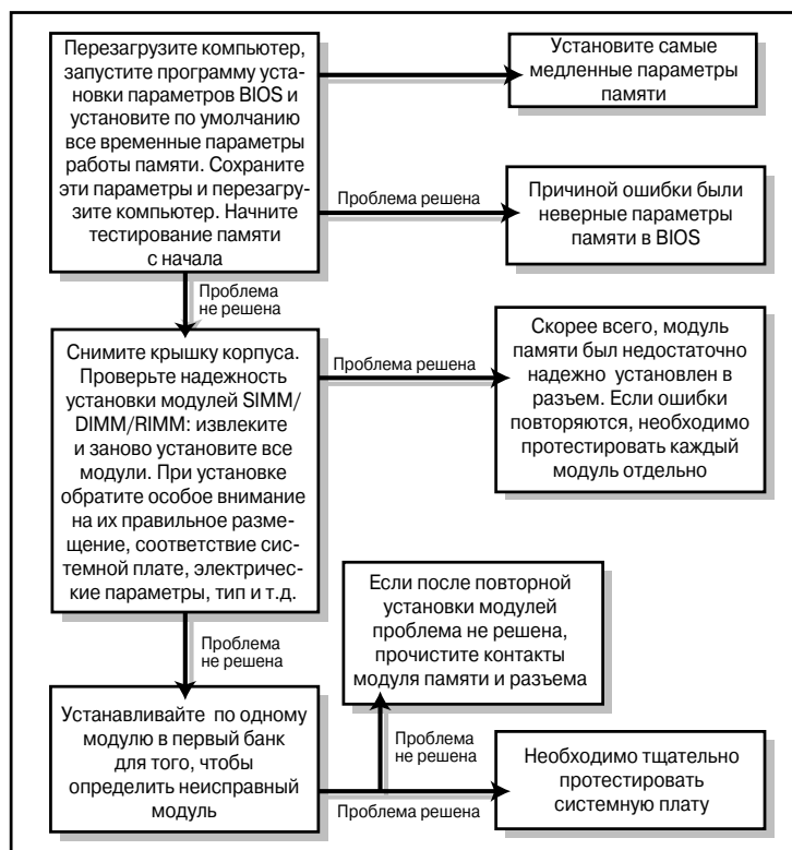
Рис. 6.21. Придерживайтесь этого алгоритма, если после выполнения действий, указанных на рис. 6.19, по-прежнему возникают ошибки памяти
