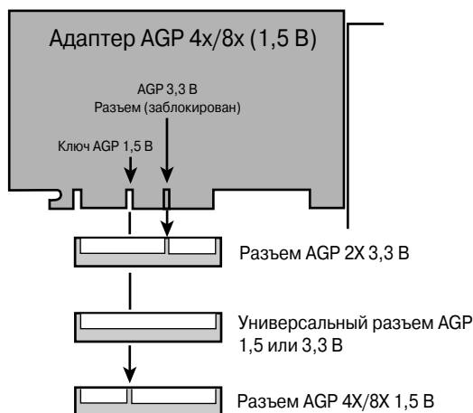
Рис. 4.52. Адаптер AGP 4x/8x (1,5 В), а также универсальный разъем AGP и разъемы для напряжений 3,3 и 1,5 В
