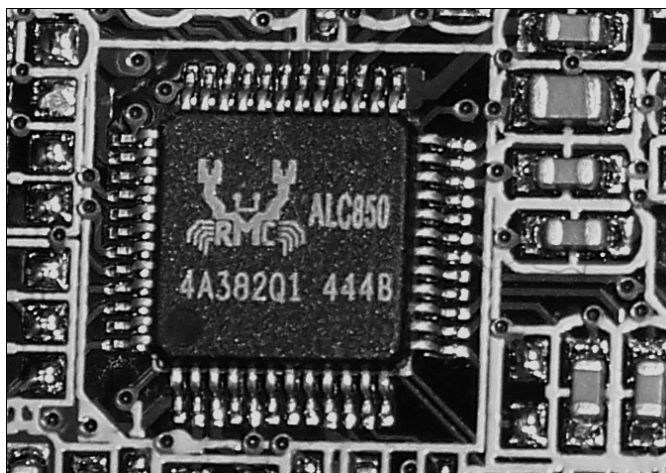
Рис. 13.4. Realtek ALC850 представляет собой типичную микросхему кодека AC'97 с поддержкой объемного звука 2.3
