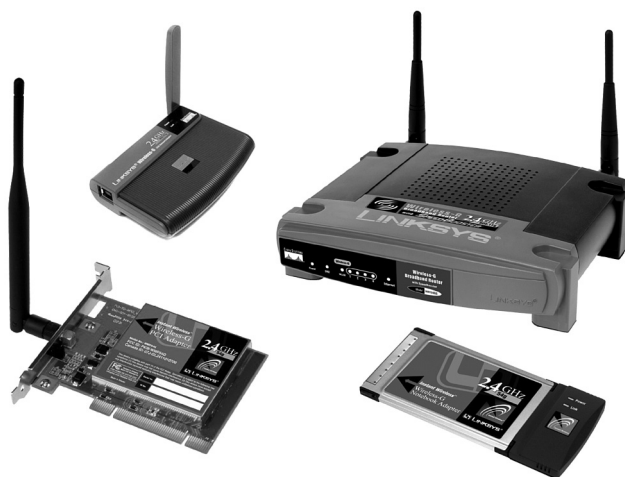
Рис. 17.20. Типичное семейство продуктов стандарта Wi-Fi с частотой 2,4 ГГц включает в себя беспроводной маршрутизатор и сетевые адаптеры USB/PC Card/PCI
