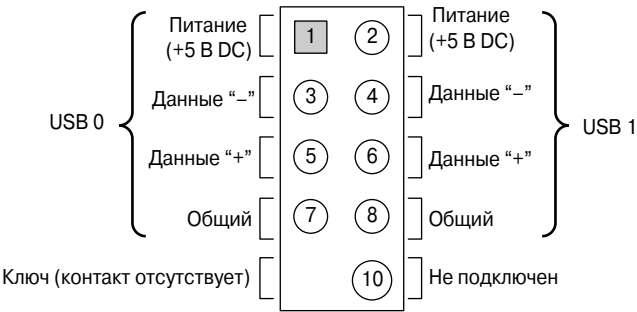
Рис. 4.33. Схема размещения контактов стандартного разьема для подключения двух портов USB
