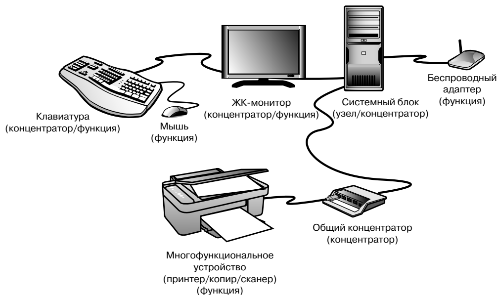
Рис. 14.4. В компьютере может использоваться несколько концентраторов USB для подключения различных периферийных устройств, причем любое устройство можно подсоединить к любому концентратору
