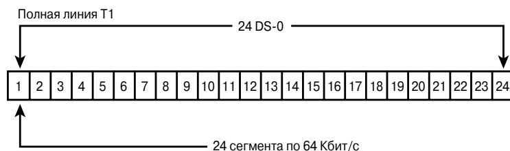
Рис. 16.4. Схема возможного разделения канала T-1
