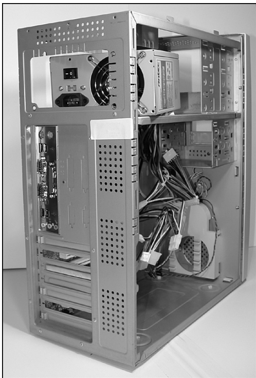
Рис. 19.16. Поместите блок питания в корпус
