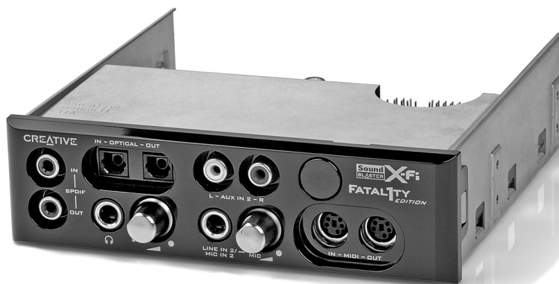
Рис. 13.2. Выносной блок аудиоадаптера Creative Sound Blaster X-Fi Fatal1ty содержит разъемы подключения MIDI-устройств, цифровые входы и выходы, удобные регуляторы громкости, стандартные гнезда линейного входа и выхода, подключения наушников, а также поддержку инфракрасного сигнала пульта дистанционного управления
