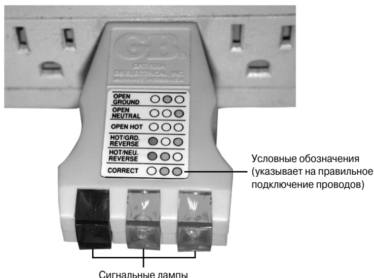
Рис. 20.8. Типичный тестер, используемый для проверки сетевых розеток
