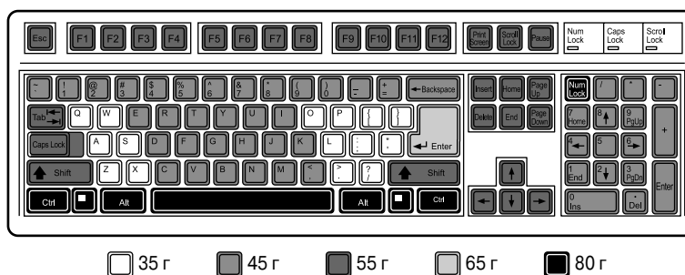
Рис. 15.5. Уровни силы для клавиатуры KeyTronic EMS, созданной на основе технологии Ergo
