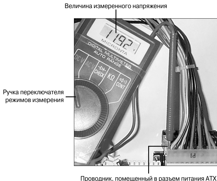
Рис. 20.6. Типичный цифровой мультиметр, используемый для тестирования 12-вольтовой цепи системной платы
